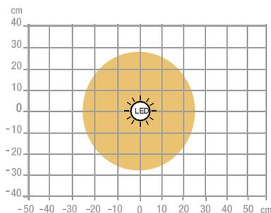
Mesure en Lux sur le plan de travail en vue de profil à 35cm
